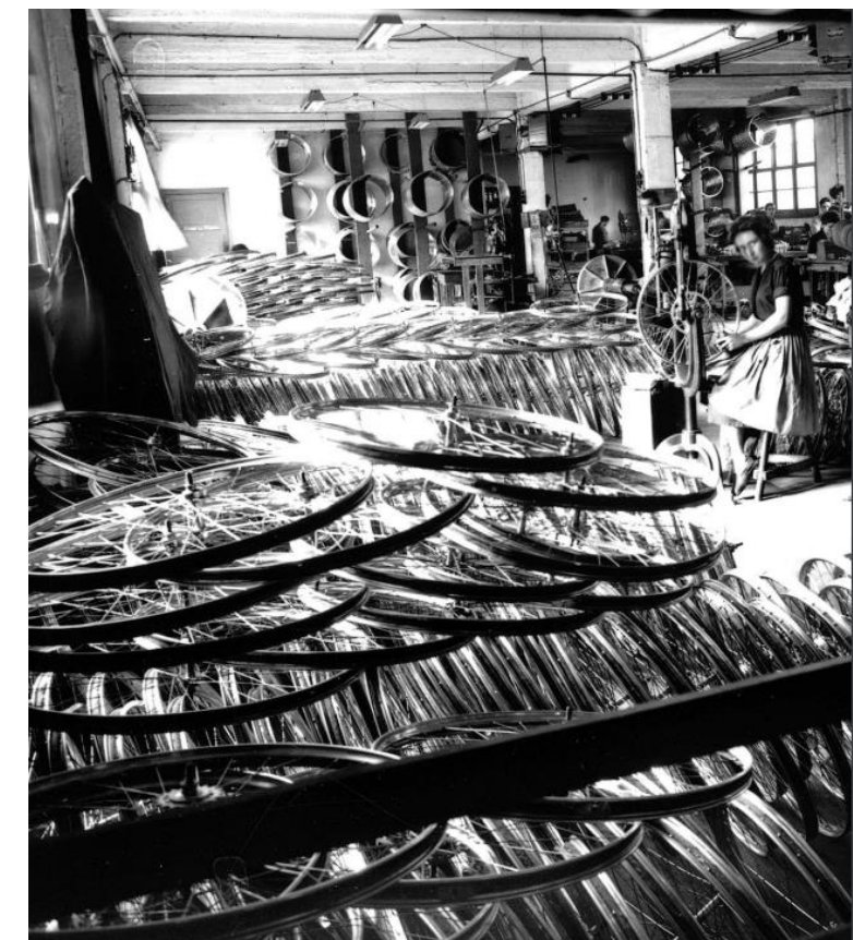
Montadoras y centradoras de ruedas en la empresa G.A.C. Fuente: Archivo Municipal de Eibar
