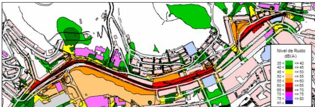
Figura 7. Mapa de ruido tráfico ferroviario (detalle de la zona centro). Periodo nocturno, Ln, dB(A). Fte AAC. 2011
