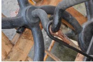
Pieza de cobre para mejorar la fricción
