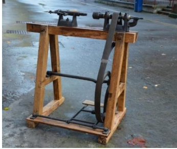
En primer término la tabla que se ha repuesto
