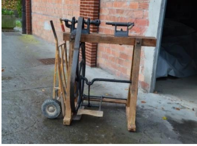
Torno de madera después de su restauración. Obsérvese el pedal, la palanca de accionamiento en la bancada y la correa.
