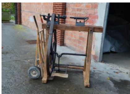
Egurrezko tornua zaharberritu ondoren. Erreparatu pedalari, bankadan eragiteko palankari eta uhalari.
